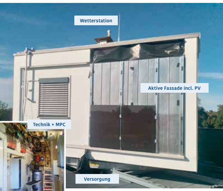
Testfassade mit modellprädiktiver Regelung am Teststand bei AEE INTEC Foto: AEE INTEC
