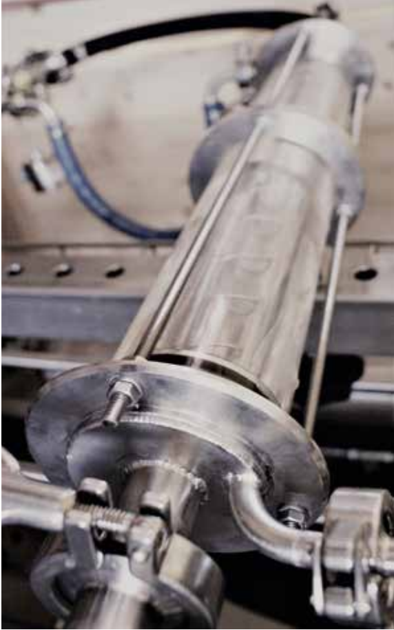
Innovatives Reaktordesign (Oszillierender Flow Reaktor) für Bioraffinerie-Anwendungen zur Gewinnung von Wertstoffen aus biobasierten Reststoffen Foto: AEE INTEC
