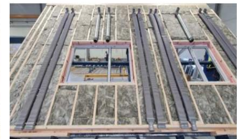
Abb.: vorgefertigte Fassadenmodul im Werk bis zum Einbau auf der Baustelle von Niersberger Group / KMT Prefab
