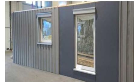
Abb.: vorgefertigte Fassadenmodul im Werk bis zum Einbau auf der Baustelle von Niersberger Group / KMT Prefab
