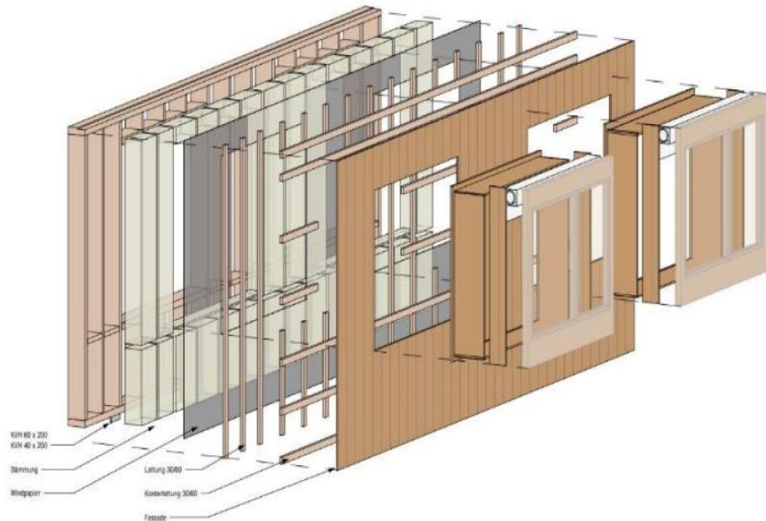
Abb.: Fassadenmodul per Knopfdruck von der Punktwolke zur Werkplanung von Renowate
