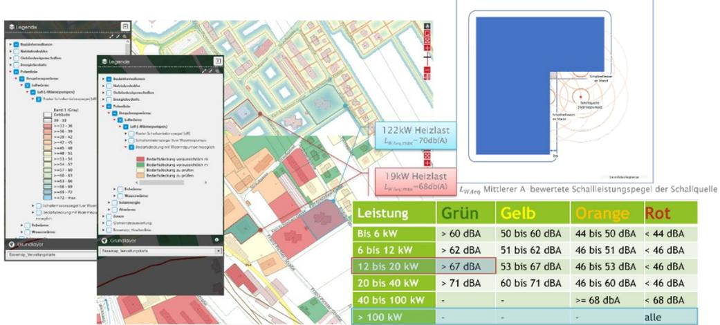
Abbildung 11: S/E/P Potenzial-Layer für Luft-Wärmepumpen in Abhängigkeit von den erlaubten Schallemissionspegeln an Grundstücksgrenzen (Eigene Abbildung)
