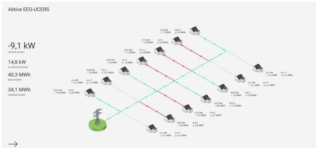
Abbildung 2: Beispiel Testbed mit COOP – Die Abbildung zeigt das Dashboard, das Echtzeitdaten zur Erzeugung, zum Verbrauch und zur Speicherung innerhalb einer Energiegemeinschaft visualisiert. Die dargestellten Informationen unterstützen die lokale Optimierung und ermöglichen den Teilnehmenden einen transparenten Einblick in die aktuellen Energieflüsse. Die Lösung wurde im Rahmen eines kooperativen Testbeds für das COOP unter realen Bedingungen erprobt (RSO).
